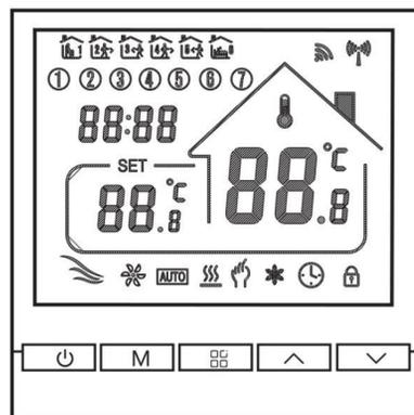
QUESTO TERMOSTATO È ADATTO PER RISCALDAMENTO ACQUA, RISCALDAMENTO ELETTRICO E CALDAIE A GAS
